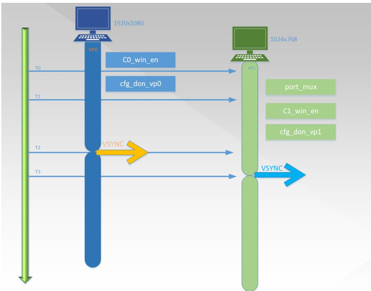
该系统有两个屏幕，分别通过 VP0(1920x1080)、VP1(1024x768) 驱动，在 T0 之前，由于 VP1 上的屏幕还未接入，所有的图层都分配给 VP0 显示。T0 时刻，VP1 上线，composer 会启动一个单独的线程，该线程发起一个 commit 把图层 Cluster1 从 VP0 迁移到 VP1，这时候 VOP 驱动会依次设置 port\_mux，enable Cluster1，cfg\_done\_vp1，(port\_mux 在 VP1 的下一个 VSYNC 到来的时刻 T3 生效)，port\_mux 生效后，Cluster1 才能被真正迁移到 VP1 上。
