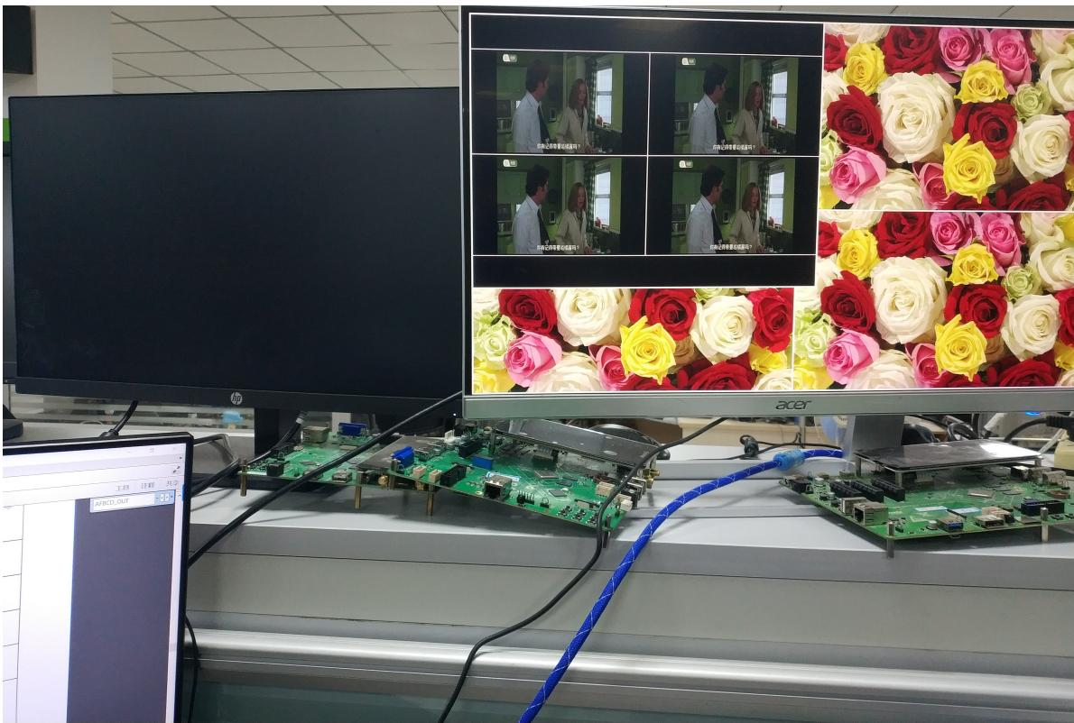
图中右边由 VP0 驱动的屏幕左上角 1024x768 的图象即为 Cluster1 显示出来的，本来是要显示在左边的由 VP1 驱动的屏幕上。
