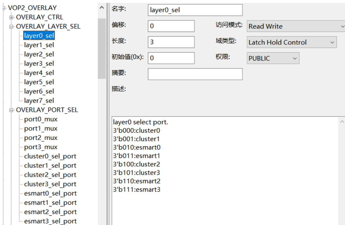
每个 VP 分配的图层数目通过 **OVERLAY\_PORT\_SEL** 寄存器中对应的 port\_mux 寄存器设置，前一级图层数目的增减会影响到后面的 VP。
