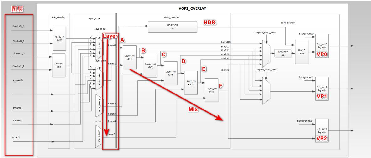
VOP2 的图层通过上图 Layer-» MIX 的逐级映射最终分配到显示端口(VP0/1/2)上。
